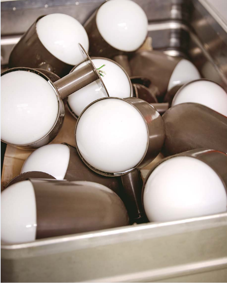
Bereits fürs «Upcycling»: Die Lampen aus dem Espenhof werden auf LED umgerüstet, bevor sie im neuen Espenhof West wieder montiert werden.
